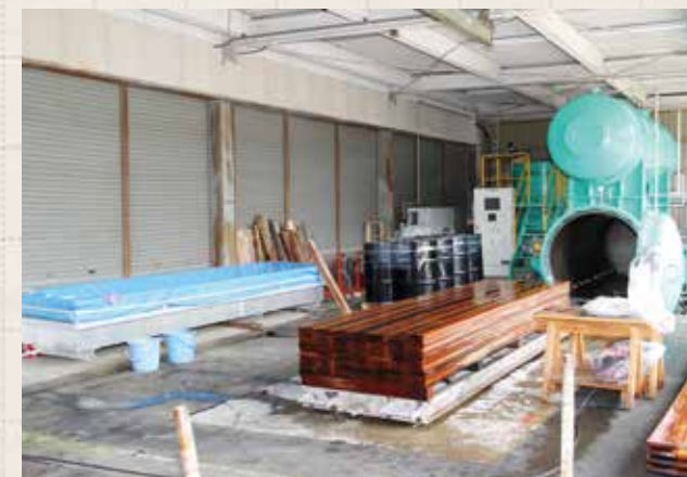
不燃薬剤を染み込ませ、不燃木材ミヤウッドを作る
