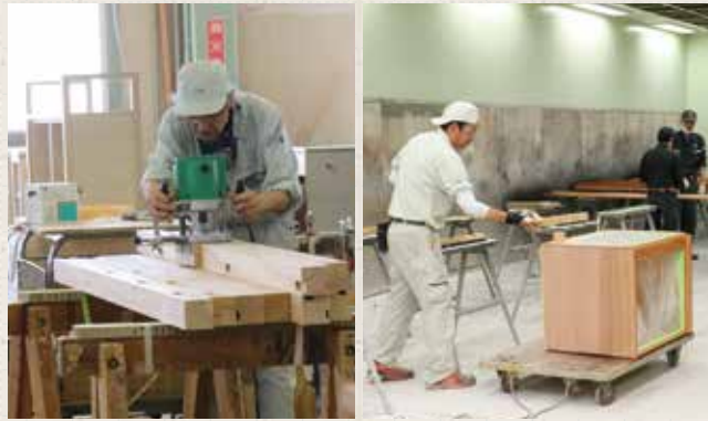
左／専属の職人による丁寧な加工 右／塗装を行う部屋は、足元から空気を吸い込み、木材への埃の付着防ぐとともに薬品の匂いから従業員を守っている。
