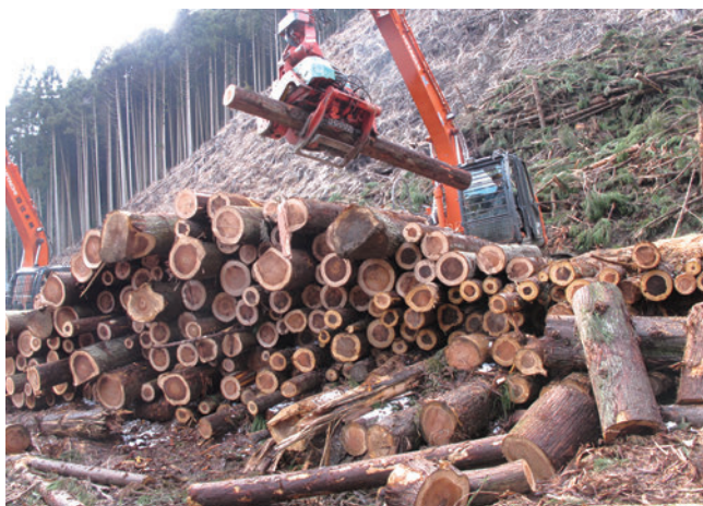
プロセッサで見る間に材が玉切りされていく
